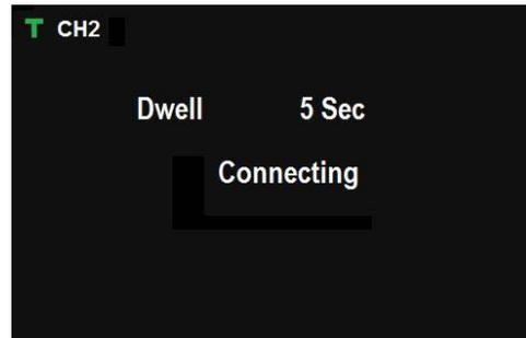
Figura 7.1 Continúe sosteniendo ambos botones para fijar el tiempo de barrido del barrido automático (Auto Scan)
