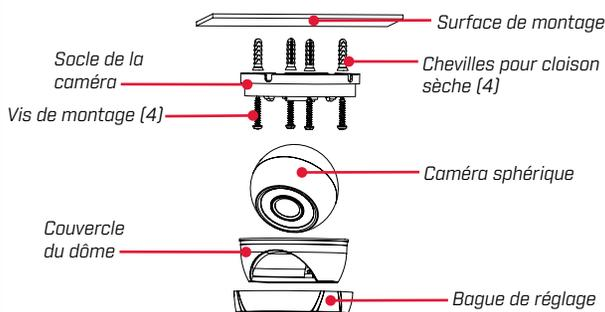
1. Faire pivoter la base de la caméra dans le sens anti-horaire pour la séparer de la caméra, de la bague de réglage et du couvercle du dôme.
