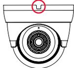
• Si les câbles passent le long du mur ou du plafond, les passer par l'encoche du support. Cela gardera la caméra à niveau sur la surface, lorsque montée.
