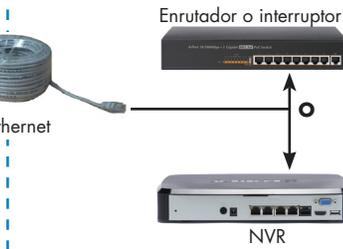
2. Conecte el otro extremo del cable Ethernet a los puertos PoE de la NVR. La cámara podría tardar hasta 1 minuto en encenderse después de haber sido conectada a la NVR.
